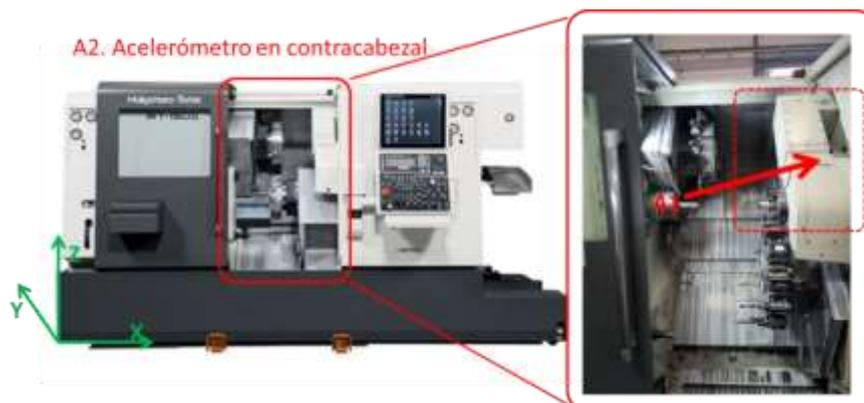
El acelerómetro se ha colocado en una zona donde se traslada el movimiento y vibración del contracabezal de la máquina
